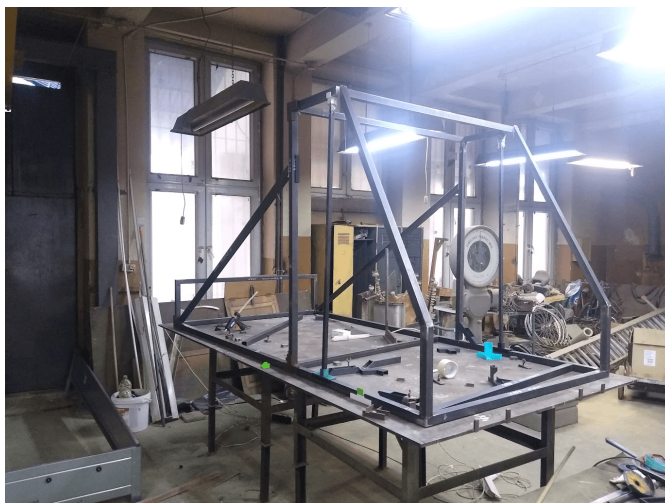
Kątowniki – ułatwiły poprawne ustawienie profili do spawania na właściwych pozycjach
